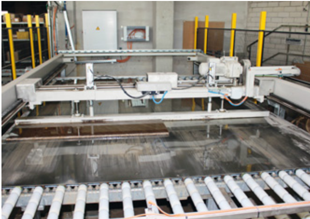
Bild 6: Querschieber in der Plattenstraße als 360°-Übergang der Fertigungsline, Pufferstrecke und Werkstückpositionierung für die viersupportige Längssäge Fotos: Dr.-Ing. Dieter Gerlach
