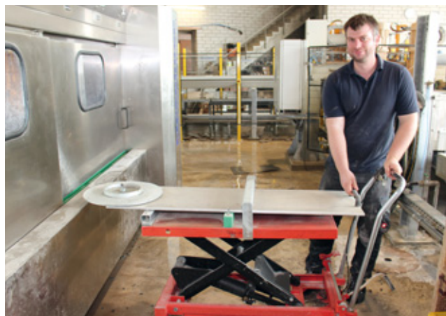
Bild 5: Kirschner Konstruktionsleiter Philipp Rottler erläutert die Vorrichtung zur Erleichterung des Schleiftellerwechsels, auf Bild 3 liegt der Schleifteller zur Montage auf dem Drehteller der Vorrichtung.
