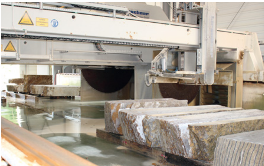
Bild 1: Plattenstreifenfertigung in der Kirchheimer Kalksteinwerke GmbH mit einer Blocksäge BSK3000 und einer Riegelsäge RSK2000 von Kirschner
